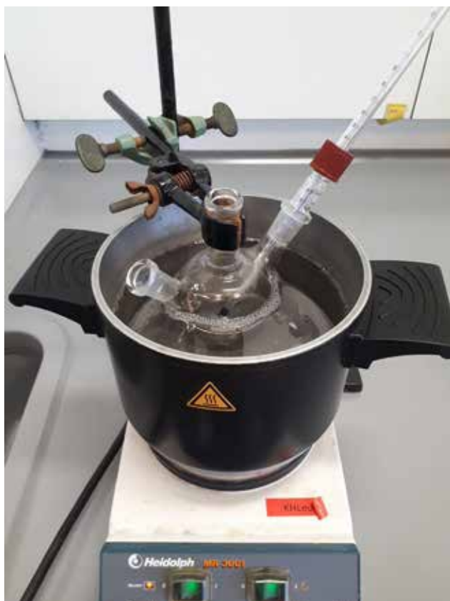
Figuur 1. Foto van de proefopstelling die werd gebruikt tijdens de synthese van de CdSe-kwantumdots.
