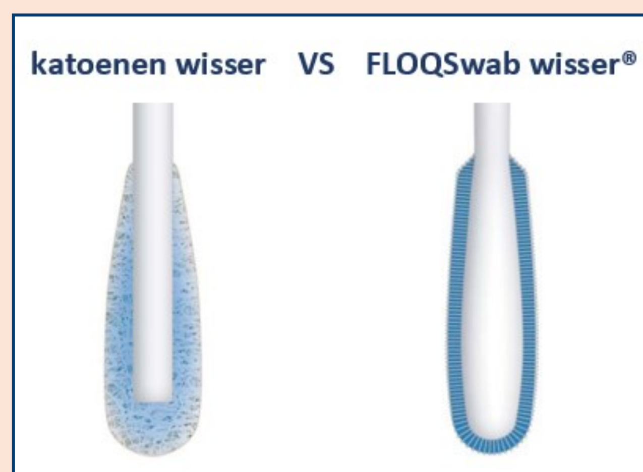
Figuur 1 structurele weergave van de tip van een katoenen wisser en een FLOQSwab wisser
